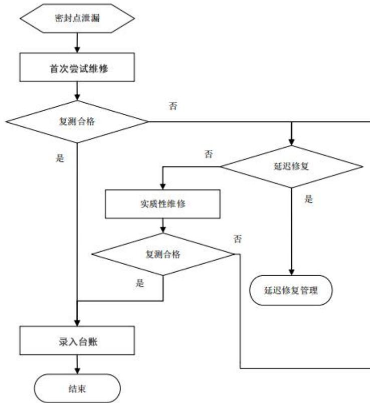
对于检测结果超过了维修定义的密封点，我们会添加包含泄漏设备群组编号、扩展编号、密封点名称、日期和 ppm 值等数据的物理标签，复测后对标签进行更新。
